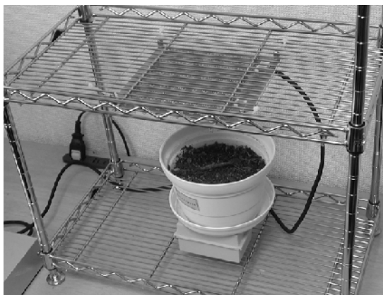
市販の組み立てラックにタイバンドでパネルを固定した例
